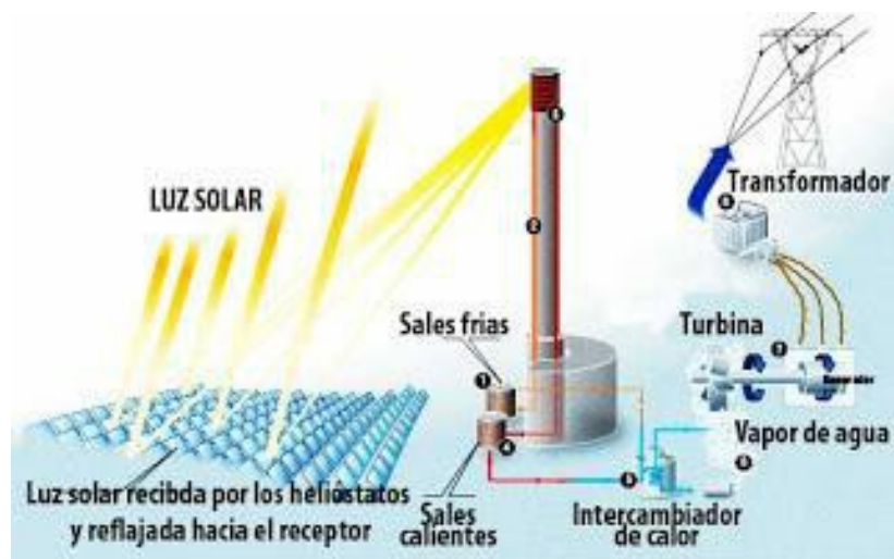
Esquema de funcionamiento Planta termosolar con sistema de acumulación de calor. Fuente: manuelricosecades.blogspot.com
