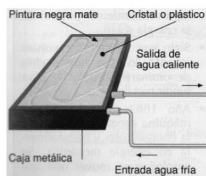
Figura 3.15. Partes de un colector.
